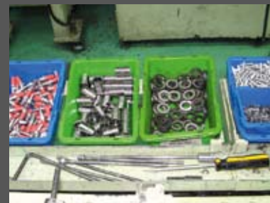
Βρισκόμαστε στο στάδιο όπου "κλείνουν" τα κάρτερ του κινητήρα. Σε πρώτο πλάνο, βίδες και εξαρτήματα "πρώτης γραμμής", που φτάνουν έτοιμα στο εργοστάσιο. Οι βίδες στα αριστερά, είναι οι "κόντρες" του ελατηρίου του επιλογέα ταχυτήτων. Το κόκκινο είναι κόλλα. Πιο δεξιά βλέπουμε spacers και ατσάλινες, παχιές ροδέλες για την καμπίνα του συμπλεκτή. Στα δύο μικρά μπλε δοχεία, διακρίνονται οι κατασβιδόβιδες που σφίγγουν τα κάρτερ, ενώ από κάτω τις σφίνες του βολάν
