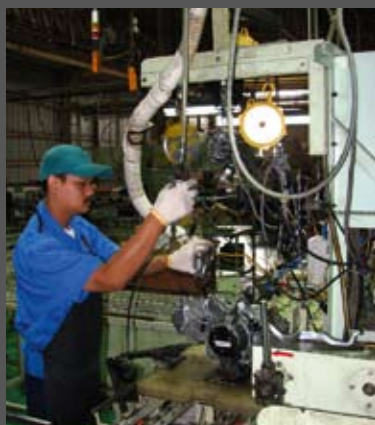
Στο τέλος της γραμμής, συνδέονται το καρμπυρατέρ, η εξάτμιση και τα ηλεκτρικά, και μέσα σε ελάχιστο χρόνο ο τεχνικός της φωτογραφίας ελέγχει αν ο κινητήρας τηρεί τις προδιαγραφές
