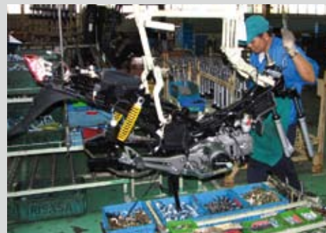
Βρισκόμαστε στην τελική γραμμή παραγωγής. Πρώτα τοποθετούνται η πλεξούδα και το κεντρικό στάντ. Αμέσως μετά ο κινητήρας και στη συνέχεια οι αναρτήσεις, οι τροχοί, το τιμόνι, τα περιφερειακά και τα πλαστικά. Εξαιρετικά ενδιαφέρουσα είναι η διαδικασία τοποθέτησης των ρουλεμάν του πλαίσιου. Σε δεύτερο πλάνο διακρίνονται οι "χύμα" μπιλίτες. Με τη βοήθεια ενός μαγνήτη και αρκετού γράσου, με ελάχιστες κινήσεις τοποθετούνται στη θέση τους
