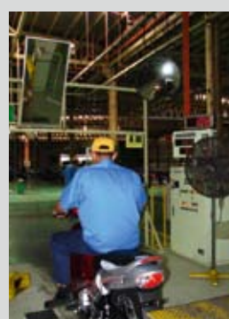
Έλεγχος κύλισης, οπτικός έλεγχος και δυναμομέτρηση. Οι τροχοί περνούν διαδοχικά πάνω από το τύμπανο και ελέγχονται η ευστάθεια του μπροστινού συστήματος, τα φρένα και βέβαια η απόδοση του κινητήρα. Ταυτόχρονα, γίνεται και έλεγχος σε όλες τις λυχνίες και στην κόρνα. Ο ανεμιστήρας και οι καθρέφτες δεν είναι διακοσμικά στοιχεία...
