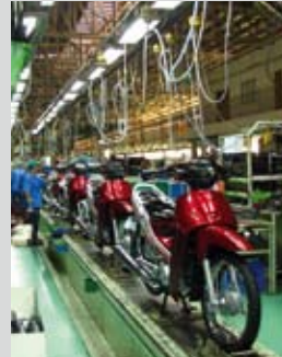
Λειτουργική, γρήγορη, καθαρή και ασταμάτητη, η γραμμή παραγωγής της Modenas. Ακριβώς δίπλα, υπάρχει και άλλη μια σαν και αυτή. Στο "ρελιαντί", μέσα σε δύο λεπτά ολοκληρώνεται ένα παπί. Το ρεκόρ, όπως μας ενημέρωσαν οι άνθρωποι της Modenas, είναι 58 δευτερόλεπτα! Καθόλου άσχημα...
