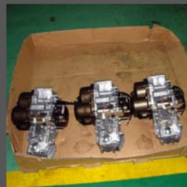
Αντίθετα, αυτοί οι τρεις απέτυχαν. Θα οδηγηθούν σε ένα ειδικό τμήμα του εργοστασίου, όπου θα αποσυναρμολογηθούν και θα επισκευαστούν. Το 99% των περιπτώσεων, οφείλεται σε προβληματικά ρουλεμάν. Πάνω στα χάρτινα ταμπλάκια, αναγράφονται τα ακριβή σκόλια του δοκιμαστή
