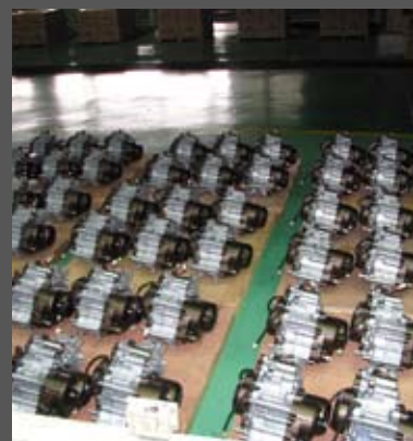
Όλοι οι κινητήρες, αφού συναρμολογηθούν και δοκιμαστούν, συγκεντρώνονται σε έναν ειδικό χώρο, και στη συνέχεια μεταφέρονται στη γραμμή τελικής συναρμολόγησης. Οι συγκεκριμένοι έχουν περάσει επιτυχώς τον έλεγχο
