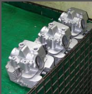
Τρεις αφινιριστές κεφαλές περιμένουν τη σειρά τους για επεξεργασία. Σε λίγα λεπτά θα έχουν αποκτήσει έδρες βαλβίδων, σπειρώματα και διόδους λαδιού
