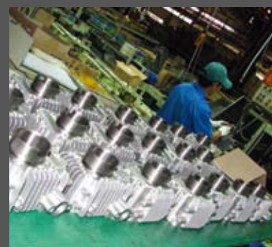
Αερόψυκτοι τετράχρονοι κύλινδροι, έτοιμοι και φρεσκοβαμμένοι, αναμένουν καρτερικά το στάδιο του ρεκτιβιέ
