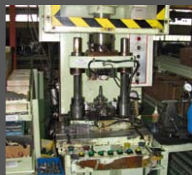
Σε αυτήν την υδραυλική πρέσα, πρεσάρονται τα ρουλεμάν και το γρανάτζι της καδένας του εκκεντροφόρου, πάνω στον στρόφαλο. Αμέσως μετά, ακουμπεί το ζύγισμα
